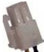
Figura 2 - Connettore aggiuntivo per scheda madre a 4 pin.
