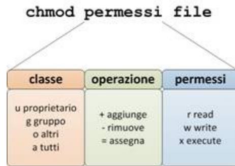
Figura 10- Assegnazione dei permessi in modalità simbolica
