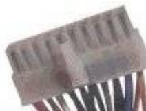
Figura 1- Connettore per scheda madre, può essere a 20 o a 24 pin o contatti.
